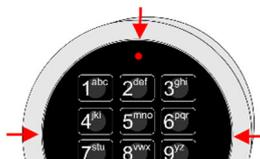
1. Выньте блок клавиш из крепления, для этого воспользуйтесь плоской, не острой отверткой, осторожно поддев блок клавиш с краю между цифрами 4 и 7, между 6 и 9, или выше светодиода (см. иллюстрацию).
