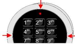
1. Suelte el teclado en su soporte palanqueándolo cuidadosamente con un desatornillador plano, no cortante en el borde del teclado entre las cifras 4 y 7, entre 6 y 9, así como por encima del LED (véase la figura).
